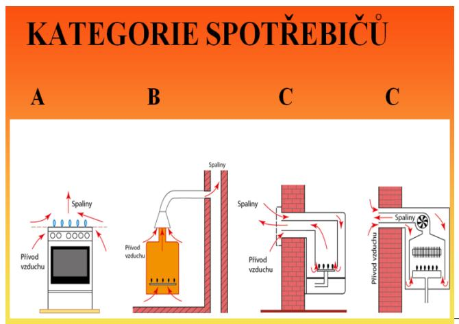
Nejvíce nebezpečné jsou spotřebiče typu B, kde je odvod spalin stále propojen s prostorem místnosti s instalovaným kotlem. Při problémech s odtahem spalin se tyto dostanou do místnosti se spotřebičem – plynovým kotlem.
